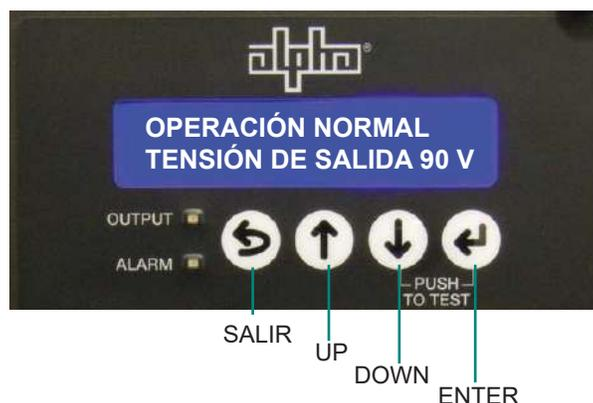
Fig. 4-2, Navegación por el visor inteligente
