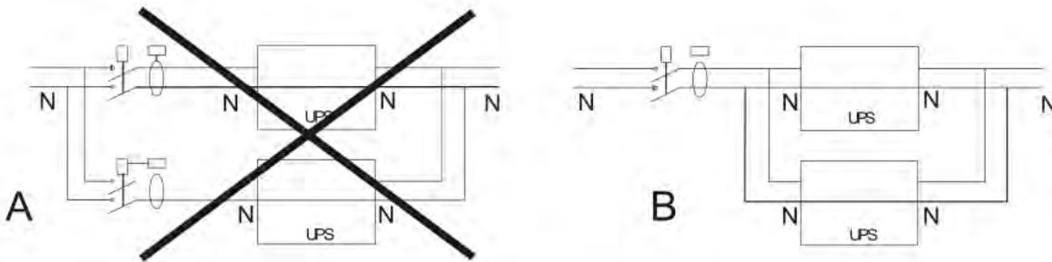
Um bei den Versionen mit mehreren parallelgeschalteten Geräten ein falsches Auslösen zu vermeiden, darf nur ein einzelner Fehlerstrom-Schutzschalter am Eingang der gesamten Anlage (siehe Abbildung B) eingebaut werden.
