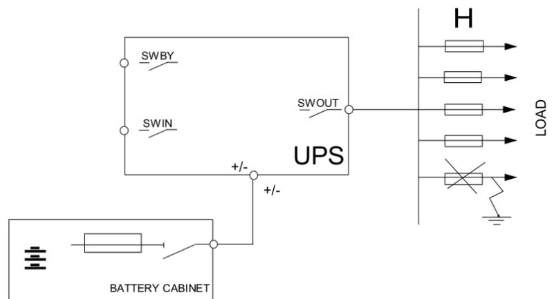
Bei **Netz-Stromversorgung** muss die Sicherung am Ausgang selektiv mit der Sicherung am Eingang sein. Dieser Zustand ist mit folgenden Werten überprüft:
