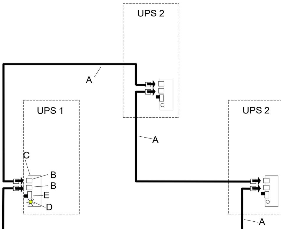
Um weitere USV in Parallelschaltung hinzuzufügen, muss ein Kabel "USV KABEL PARALLELSCHALTUNG" für jede neu angeschlossene USV hinzugefügt werden.
