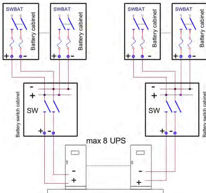
**Anschluß mehrerer USV-Anlagen an eine Batterie:**
