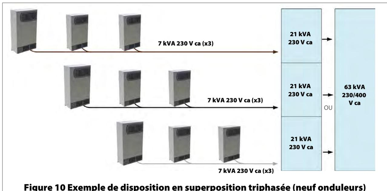
**Figure 10 Exemple de disposition en superposition triphasée (neuf onduleurs)**
