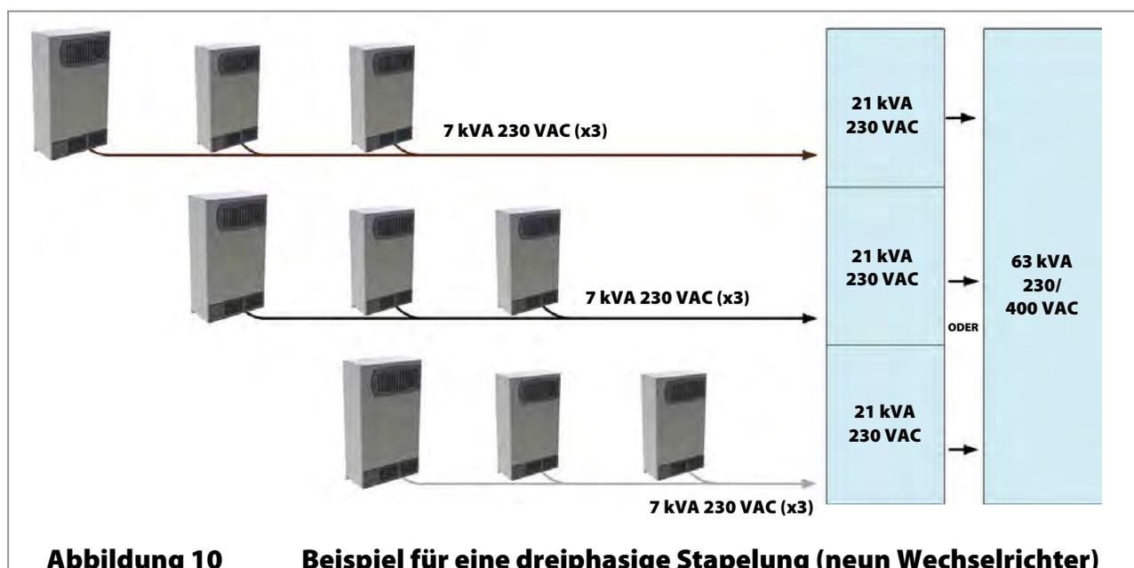
**Abbildung 10 Beispiel für eine dreiphasige Stapelung (neun Wechselrichter)**
