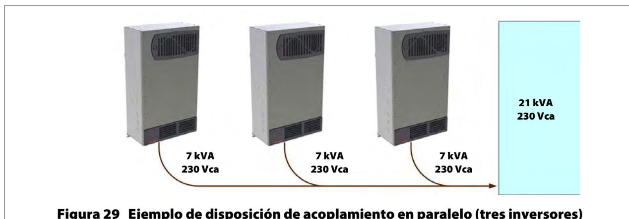
**Figura 29 Ejemplo de disposición de acoplamiento en paralelo (tres inversores)**
