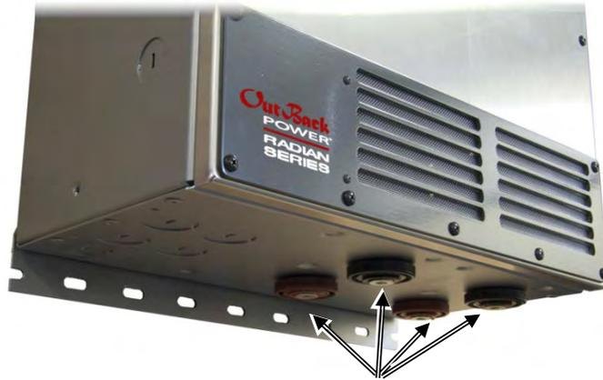
**TERMINALES DE CC:** conectan con los cables de la batería y el sistema de CC. Hay dos terminales CC positivos y dos terminales CC negativos. Cada terminal CC positivo requiere cables separados y protección contra sobrecorriente separada. Consulte la página 23 para obtener instrucciones.
