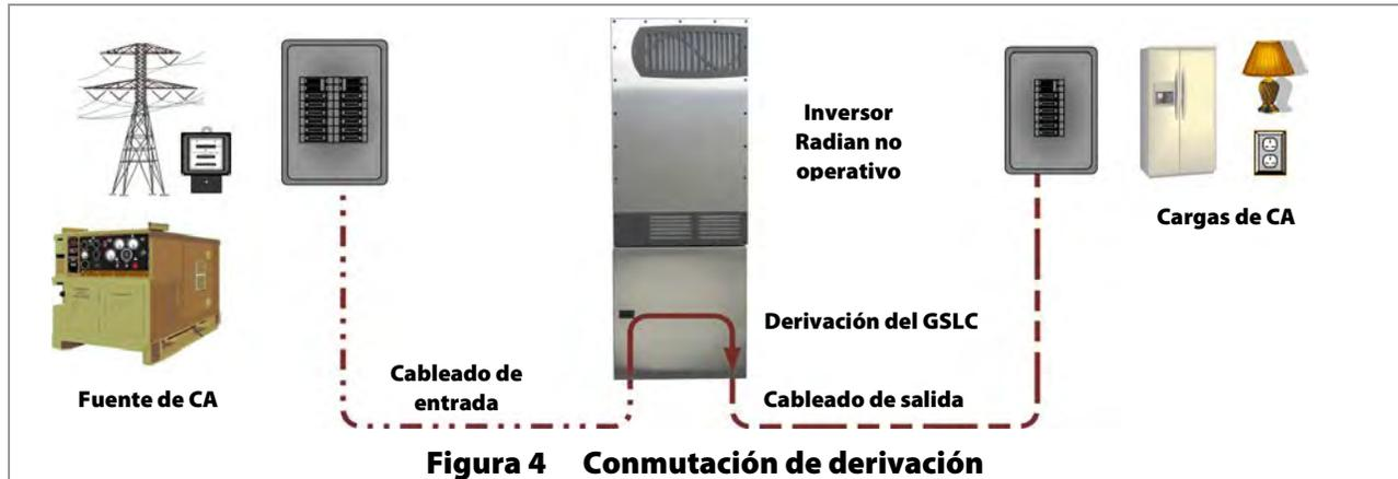
El tablero de distribución GS (GSLC) se puede equipar con interruptores de derivación para este fin. No obstante, si hay varios inversores Radian acoplados en un solo sistema, no se deberían utilizar los kits de derivación de GSLC. La función de derivación debe ser simultánea para todos los inversores. Los kits de derivación de GSLC operan independientemente, no simultáneamente.
