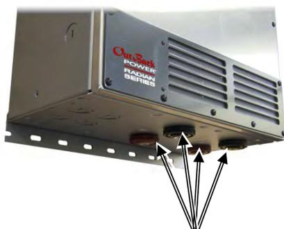
El inversor Radian tiene cuatro terminales de cable de batería, dos positivas y dos negativas. Cada terminal es un orificio roscado que admite un tornillo (incluido). En la siguiente página encontrará información sobre el montaje y cableado.
