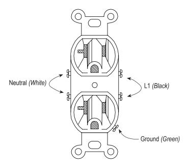
Fig. 2-7, 520-R Receptacle Wiring
