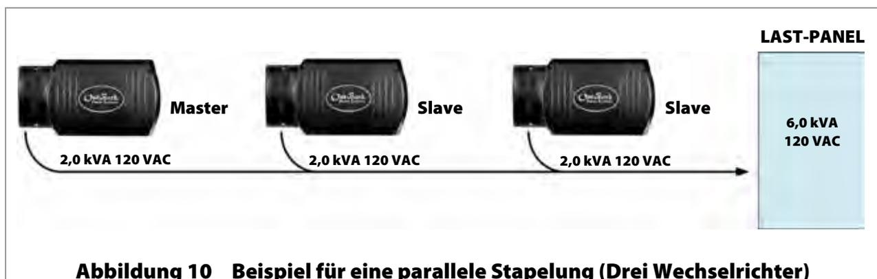
**Abbildung 10 Beispiel für eine parallele Stapelung (Drei Wechselrichter)**
