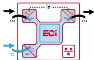
Der modulare Wechselrichter Bravo 10 ist mit **1 bis 32 Modulen** und mehreren **Optionen** (manueller externer Bypass und AC-Verteilung) verfügbar. Er lässt sich auch **im laufenden Betrieb wechseln (Hot Swap)**, was eine sehr einfache und kostengünstige Wartung erlaubt. Die Module werden mit unserer neuen Überwachungslösung Inview geliefert.
