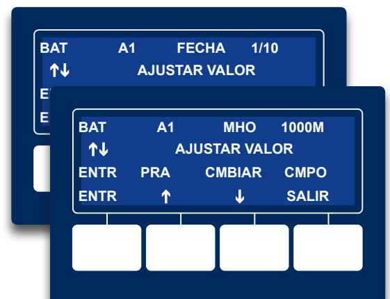
Fig. 2 - Entrada de los datos de código de fecha y MHO de la batería
